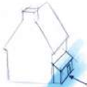
Appentis ou galerie fermée permettant un préchauffage de l'air entrant.
