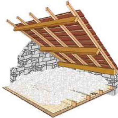
Isolation d'un comble perdu par déversement d'isolant en vrac.
